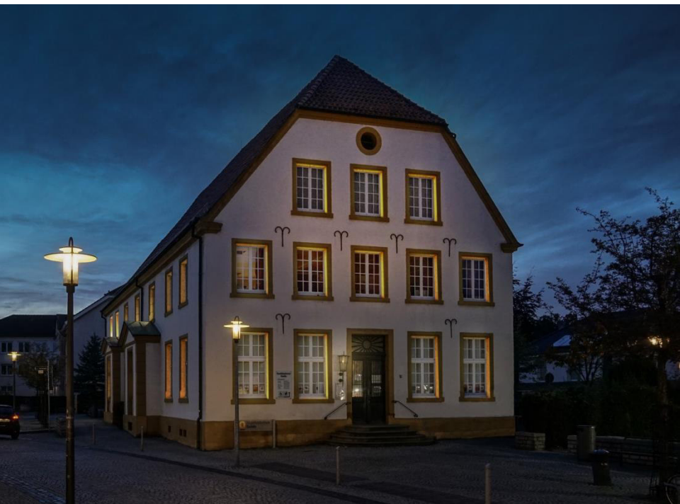
Variante 1: Beleuchtung der Fensternischen mittels geeigneter Leuchte und leichte Fassadenaufhellung
